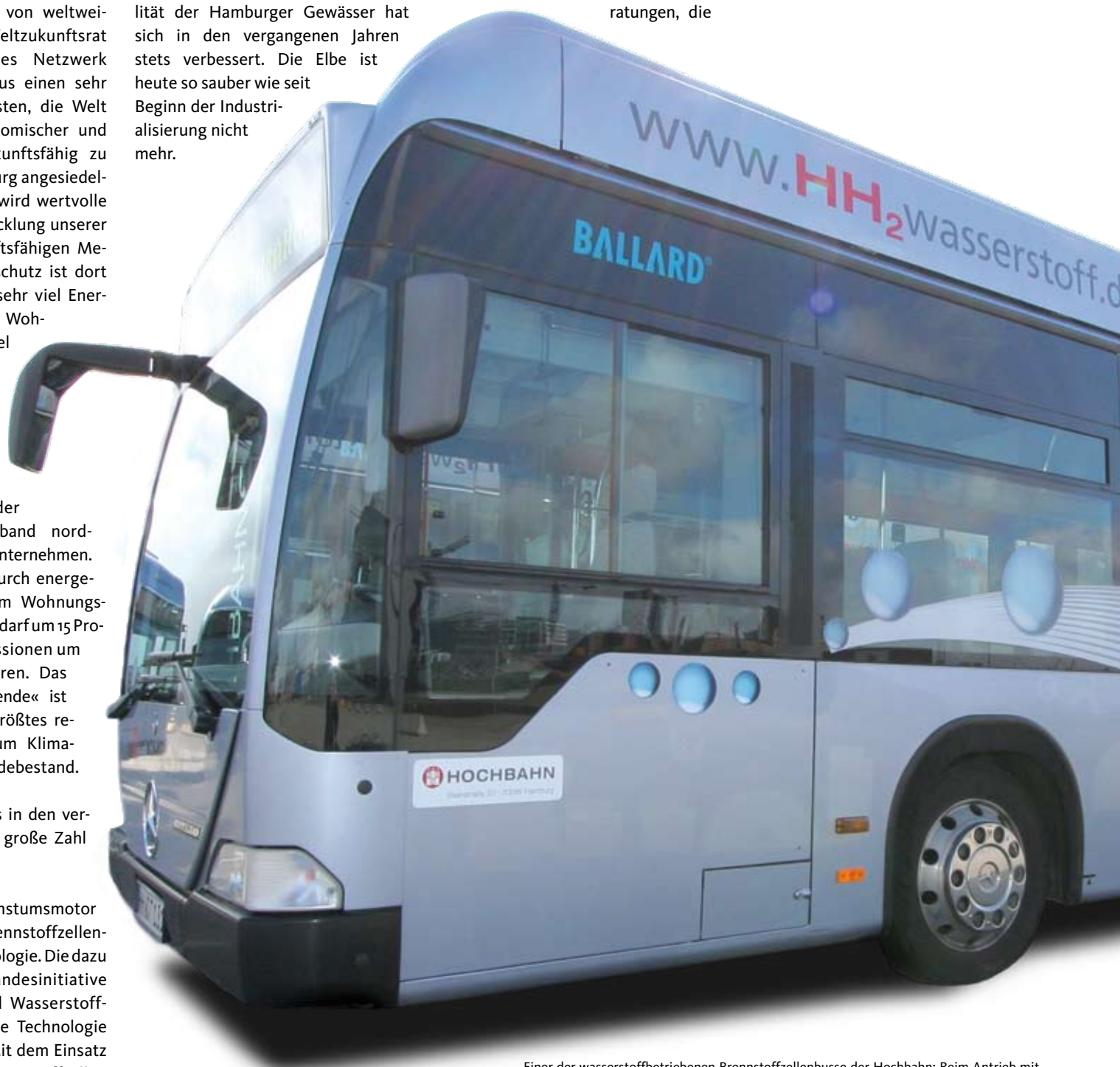
Einer der wasserstoffbetriebenen Brennstoffzellenbusse der Hochbahn: Beim Antrieb mit Brennstoffzellen entsteht als Abgas lediglich Wasserdampf. Zusätzlich wird beim Bremsen Energie in Strom umgewandelt, in einer Batterie gespeichert und für den Antrieb genutzt. Die vollständig emissionsfrei fahrenden Hybridfahrzeuge verbrauchen 50 bis 60 Prozent weniger Energie als herkömmliche Busse.
